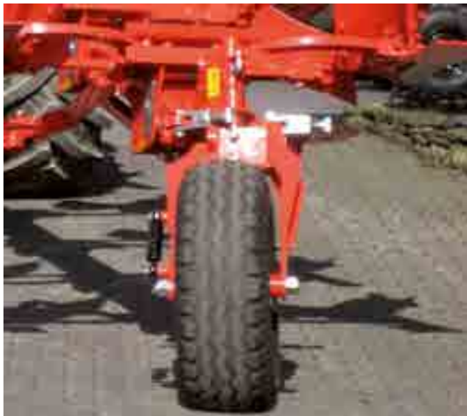
↓ Arbeits- und Transportrad 680 x 260 mm (für AT 65) unten links 800 x 300 mm (für AT 85) unten rechts
